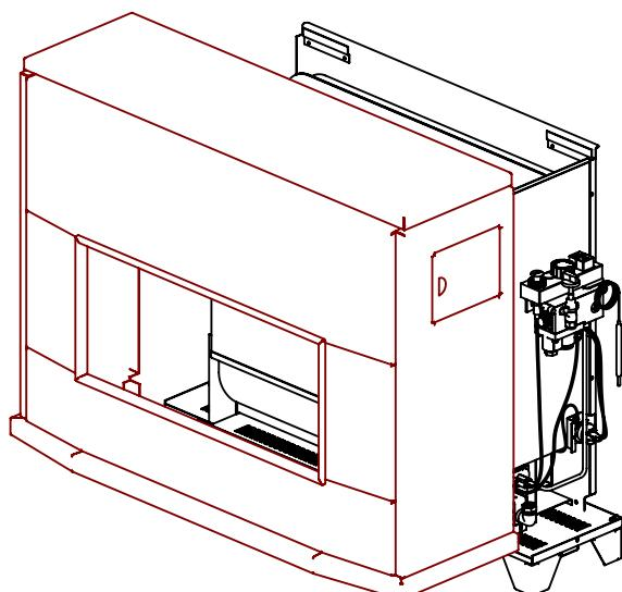
Schroef de 3 parkervijzen los bovenaan de ruit met een platte sleutel 8. Vervolgens kan u de bevestigingslat verwijderen.
